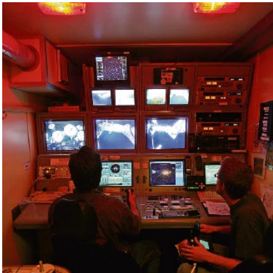
Zentrale auf einem Bohrschiff zur Fernsteuerung eines Unterwasservehikels von Subsea 7.
