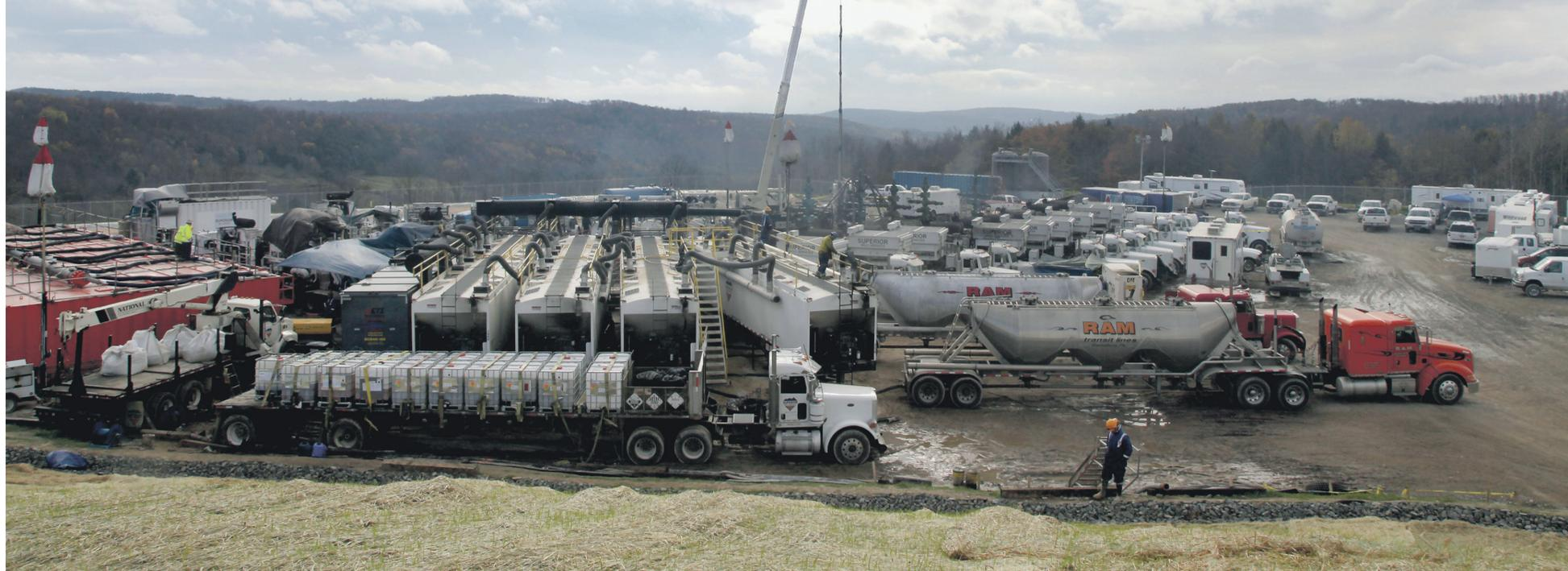
Arbeiter überwachen das Abladen von Sand an einer Gasproduktionsstätte von Southwestern Energy in Camptown, Pennsylvania. Sand bildet zusammen mit Wasser und Chemikalien Teil eines Gemischs, das mit hohem Druck in das Bohrloch eingepresst wird, um das Schiefergestein aufzusprengen und dem Gas den Weg freizulegen.
