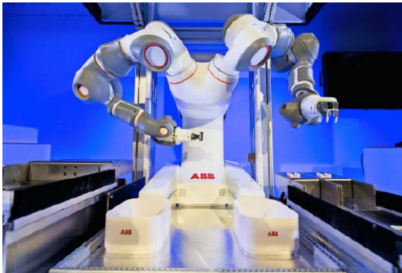
Der neue Industrieroboter YuMi ermöglicht in der Kleinmontage erstmals eine sichere Mensch-Maschine-Zusammenarbeit.
