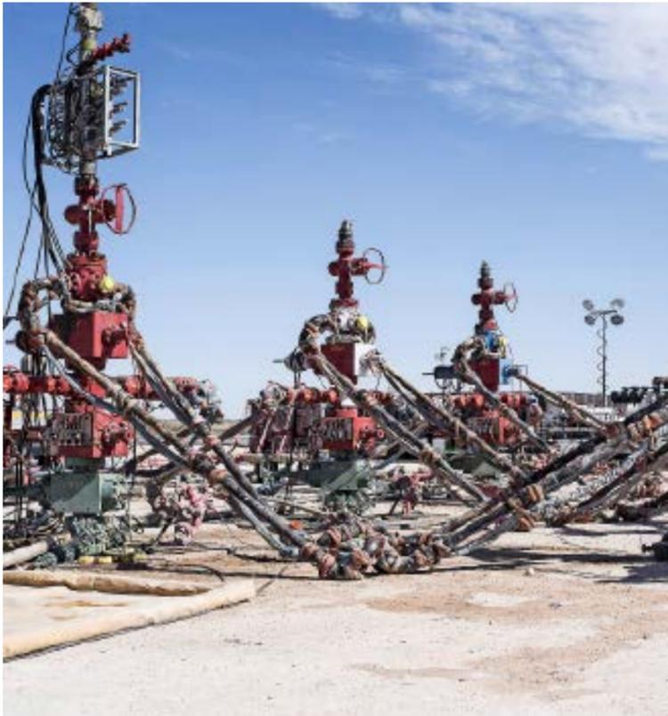
Fracking-Gerät zum Aufbrechen von Schieferöl- und -gasgesteinsformationen.
