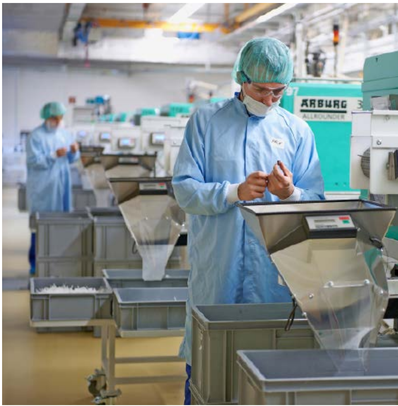
Die Produkte von Applicator Services werden im Spritzgiessverfahren hergestellt.
